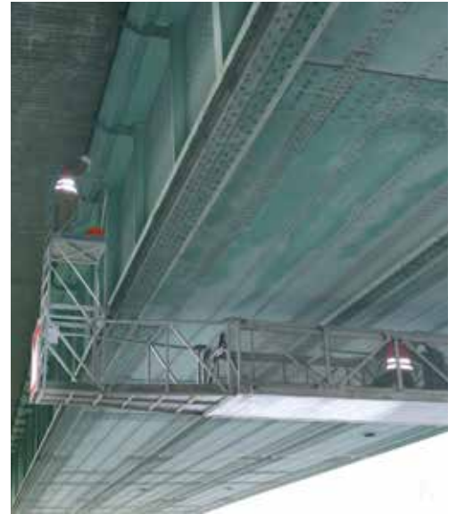
Einsatz mit Stegverlängerung auf 19,00 m Reichweite: 19,70 m
